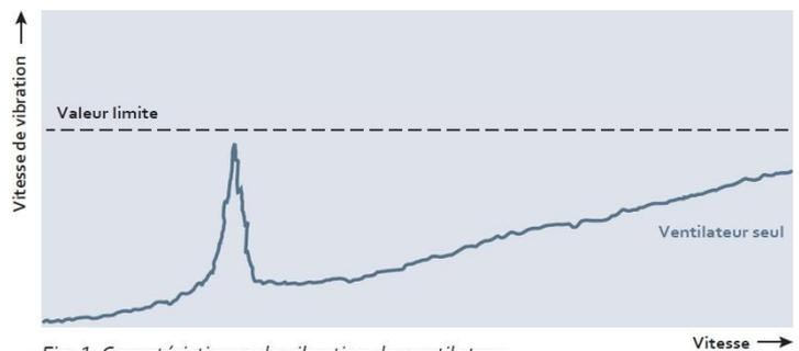
Fig. 1: Caractéristiques de vibration du ventilateur
