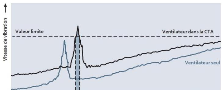
Fig. 4: Caractéristiques de vibration, la plage de vitesse n'étant pas prise en compte
