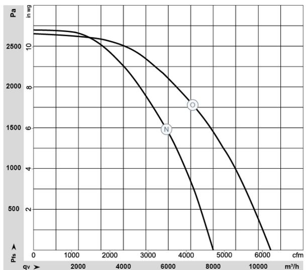
Performance aéraulique mesurée selon : ISO 5801, catégorie d'installation A, avec pavillon d'aspiration ebm-papst sans protection contre le contact.
