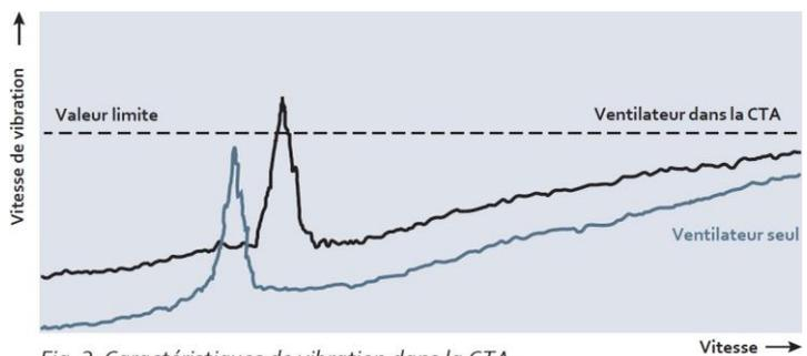
Fig. 2: Caractéristiques de vibration dans la CTA
